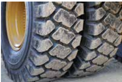
Höhere Aufstandsflächen von Zwillingsreifen sorgen für mehr Halt auf dem Waldweg und bessere Gewichtsverteilung auf die Straßen.
