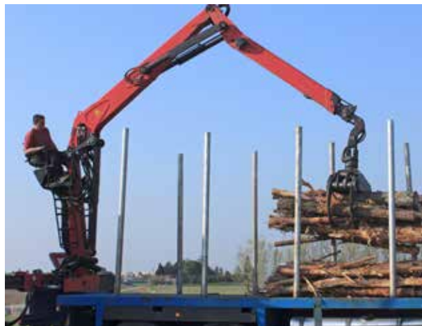
Kurzholzfahrzeug mit Aluminiumrungen
